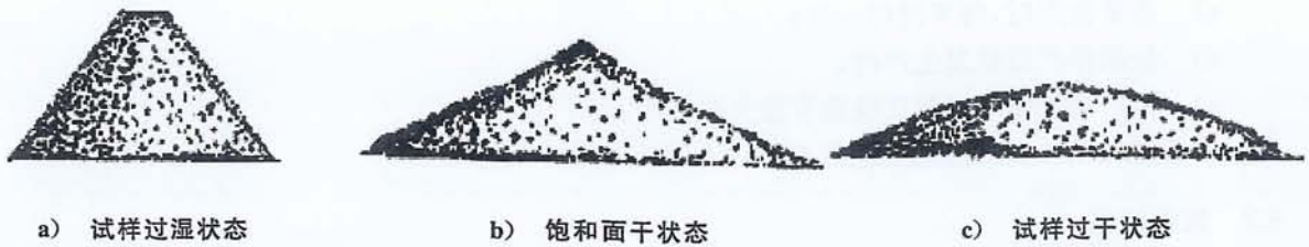
图4 天然砂饱和面干状态示意图
